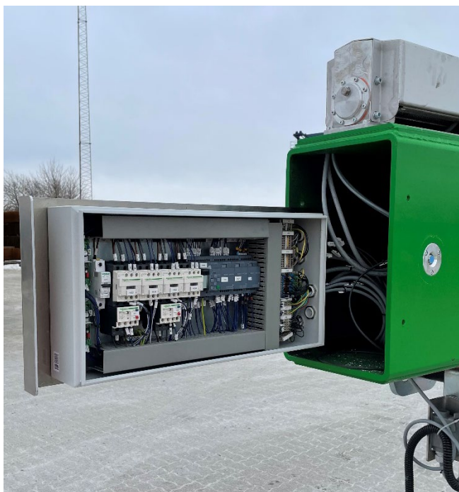
Styretavle er placeret i åget på glideskinner
